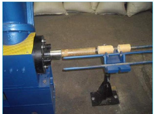
Лінія з виробництва паливних брикетів
